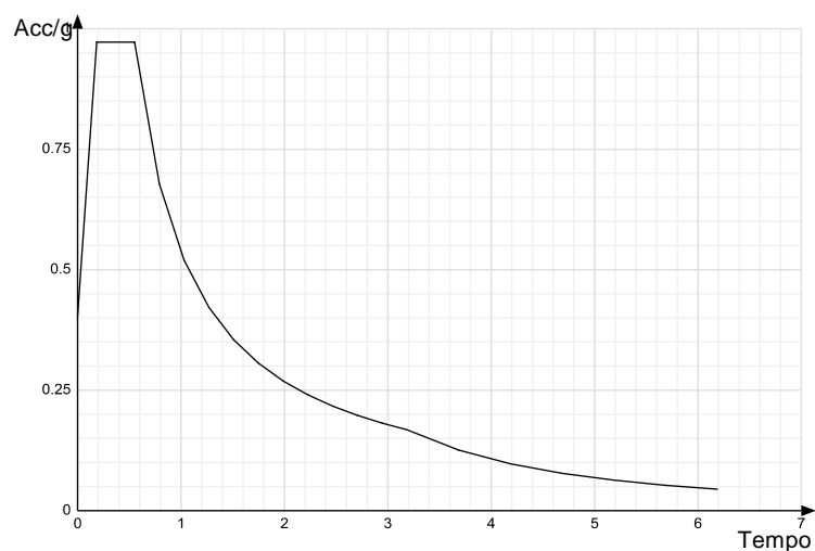
Spettro di risposta di progetto in accelerazione delle componenti orizzontali SLO § 3.2.3.4
